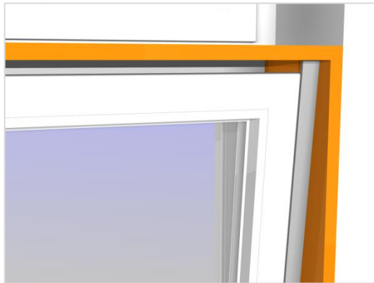
Abbildung 8 Abdichtung der seitlichen Fensterspalte gegen ungewollt eintretende Außenluft.
