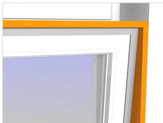
Abbildung 9 Erweiterung der Abdichtung auf den oberen Fensterspalt.
