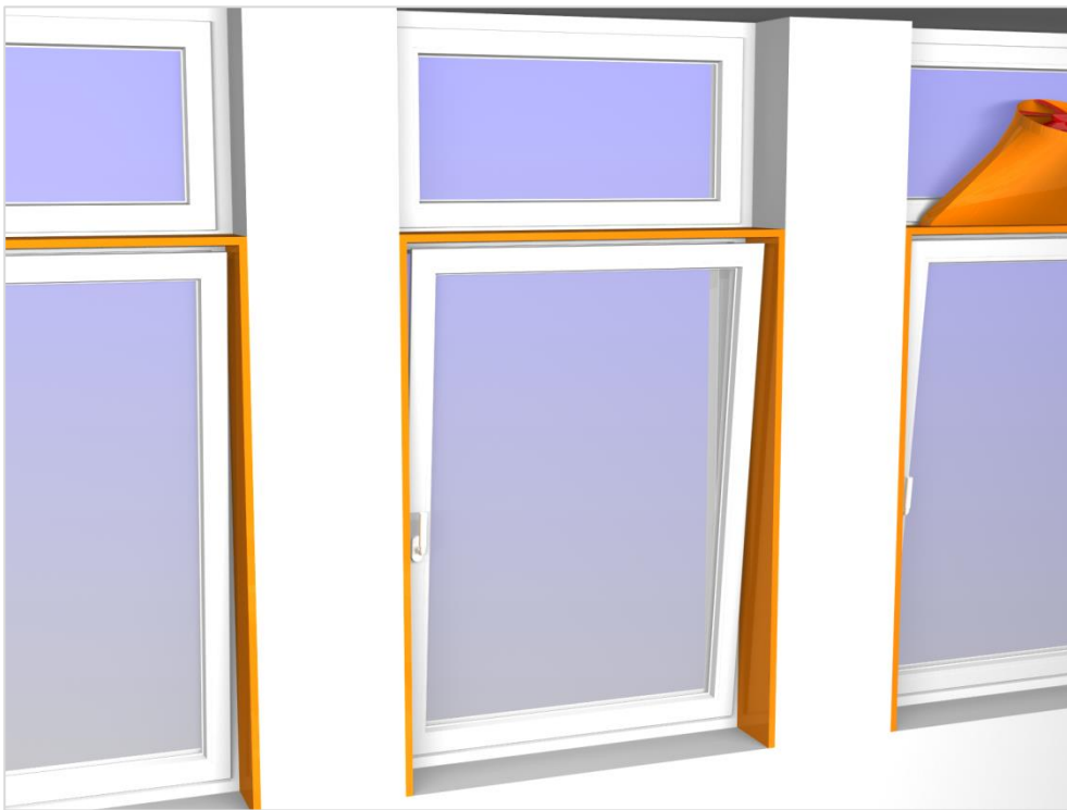
Abbildung 7 Umbauung der Kippfensterflügel mit schallabsorbierenden Platten als einfache Maßnahme gegen Außenlärm. Der WindowBooster wird durch einen Ausschnitt in der Platte gesteckt. Die Fenster bleiben uneingeschränkt nutzbar.
