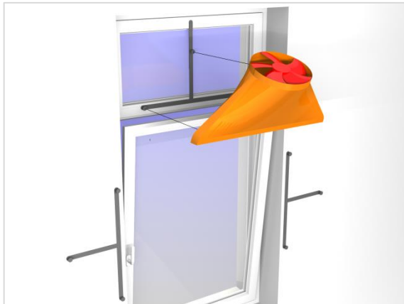
Abbildung 4 Der WindowBooster wird in eine fest montierte 3-Punkt Halterung eingehängt, die am Rahmen des Oberlichts oder beiderseits des Fensters verwendet werden kann.
